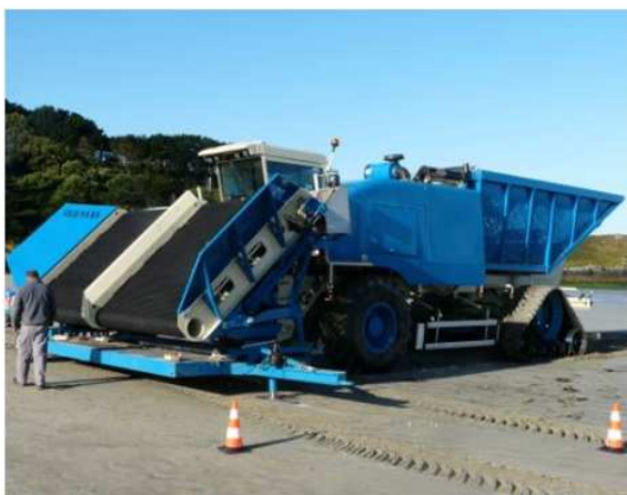
Engin de ramassage des algues vertes dans le rideau modifié par la société Agrival
